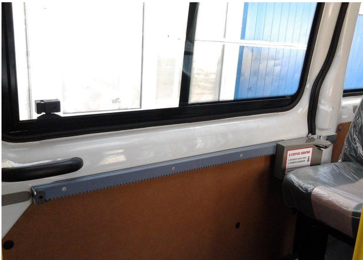
Введите в зацепление с сектором рейки шестерню привода подняв до фиксатора кронштейн аварийной разблокировки. Отверните бугеля в которые защелкиваются штатные замки, либо зафиксируйте замки дверей в открытом положении. После этого можете включить предохранитель в цепь электропривода. После подачи напряжения в течении 10 секунд привод принимает команды на обучение блока управления от брелка дистанционного управления.
